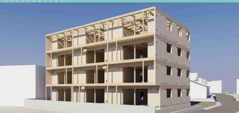
CLTパネル工法による「耐震性」と耐火構造による「安全性」、外断熱工法と2重床遮音工法、1LDK-8戸と3LDK-4戸すべて対面型キッチンを採用し、ワンランク上の「居住性」を低コストで実現した「CLT36MS (CLT-3.6mモジュール標準化システム)」による4階建木造CLTデザイナーズマンションマンションです。
